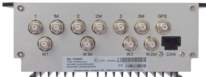
A l'arrière de l'appareil, sur la rangée supérieure, vous trouverez les connexions pour les modems radio mobiles (WWAN 1-3) et leurs connexions MIMO WWAN 1M-3M et GPS. La rangée inférieure contient les connecteurs pour les antennes WLAN W1/W1M et le connecteur CAN.
