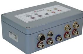
Mobiler WLAN-Router mit Anbindung an das Internet über doppelt ausgelegte und aktiv parallel betreibbare LTE-Mobilfunkverbindung.
